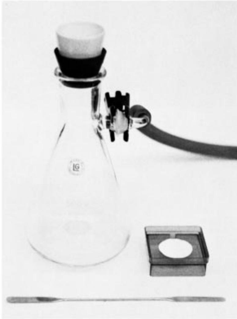
**FIG. 2 Filtration Apparatus**
